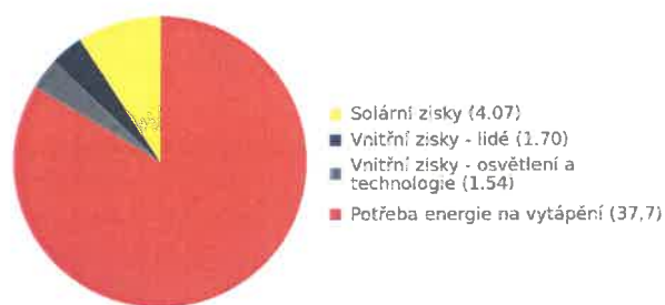
Bilance potřeby energie na vytápění (MWh/rok)
